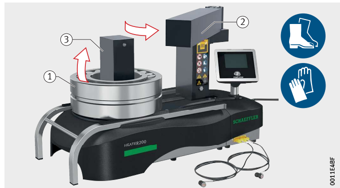
Рисунок 50 Снятие горизонтально уложенного подшипника качения
